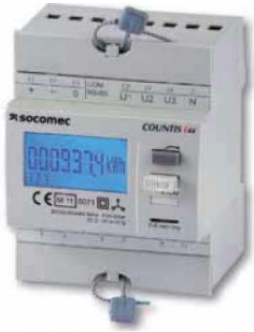
Счетчик **COUNTIS E4x** - это модульный счетчик активной и реактивной электроэнергии, отображающий энергию и потребляемую активную мощность (кВтч, кВАч и кВт) непосредственно на ЖК-дисплее с подсветкой. Он предназначен для измерения трехфазной нагрузки с подключением через ТТ и подходит для устройств с нагрузкой до 6000 А (3000 А для MID). COUNTIS E42, E44 и E46 сертифицированы MID.
